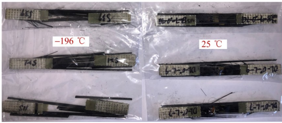
图8 不同温度下单向板拉伸断裂形式
